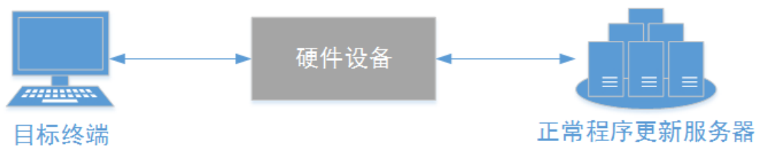
图 9 利用硬件设备劫持流程示意图（APT-C-01 组织）
