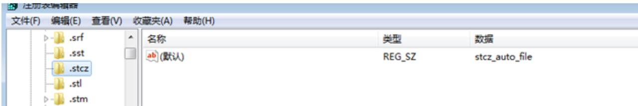
而从HKEY\_CLASSES\_ROOT\stcz\_auto\_file\shell\open\command的值可以知道，InterMgr 0.17.stcz在开机时被打开后会调用rundll32，运行%userprofile%\AppData\Local\Microsoft\FEO3-9g\目录下的木马dCh8RnL1.Odo。
